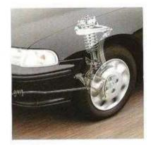
perfektionierte DoubleWishbone-Aufhängung an allen 4 Rädern ist eine der technisch elegantesten Lösungen für eine präzise Radführung. Zusammen mit dem verstärkten Chassis und der präzisen Lenkung verleiht sie dem Accord ein äußerst sicheres und angenehmes Handling auf allen Straßenbelägen.
