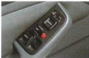
Über Türschaltelemente lassen sich die elektrischen Fensterheber und die elektrisch verstell- und beheizbaren Außenspiegel bedienen.
