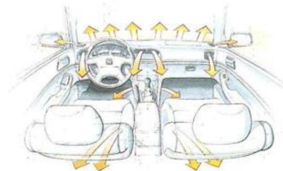
Das Heiz- und Lüftungssystem wird über Drucktasten gesteuert und führt frische Luft in den Fahrgastraum. Ein Umluftgebläse verhindert das Eindringen von Abgasen – besonders wichtig bei starkem Verkehr. Eine manuell bedienbare Klimaanlage ist serienmäßig eingebaut. Im Sommer sorgt sie für angenehme Temperaturen im Fahrzeuginnern, im Winter für klare Sicht.
