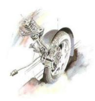
■ Die Double-Wishbone-Einzelradaufhängung ermöglicht ein leichtes Handling und optimiert das Fahrverhalten.
