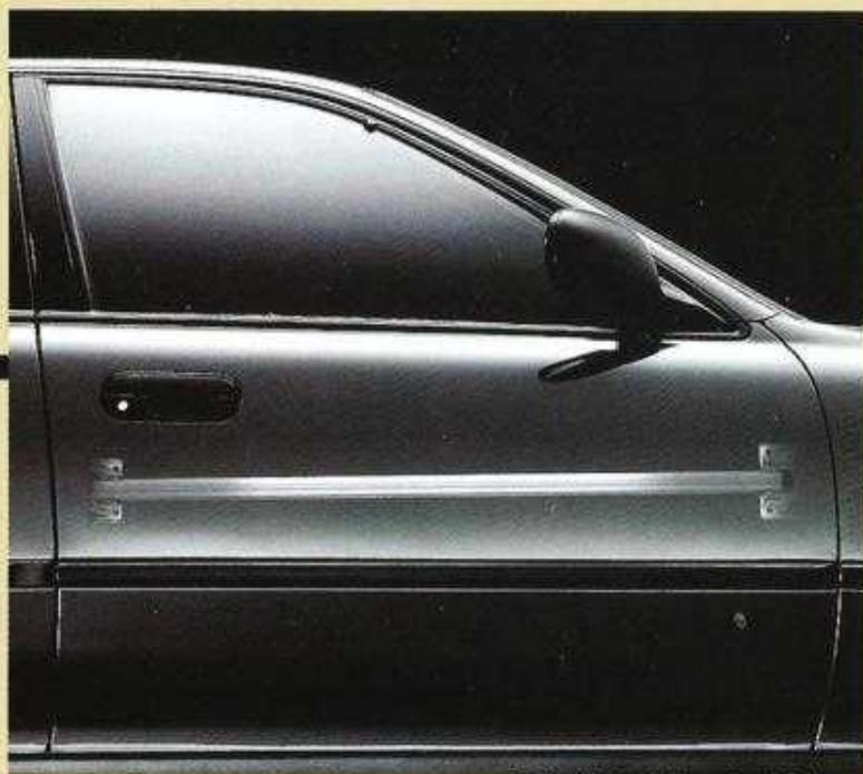
Stabile, vertikal eingezogene Seitenholme in den Türen bürden in Verbindung mit dem verstärkten Chassis für hohen Seitenaufprall-Schutz.
