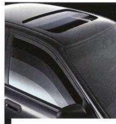
*Äußerst angenehm: Mit dem "Easy locking" System des ES Modells können Sie per Schlüsselumdrehung an der Fahrertür nicht nur das Honda-Alarm-System aktivieren, sondern gleichzeitig auch alle Fenster und das elektrische Schiebedach schließen. Mit einem Infrarot-Code läßt sich die Fahrertür schlüssellos auf- und zuschließen.*
