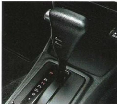
Im Sport-Modus werden die Schaltpunkte für die Gänge in höhere Drehzahlbereiche verlagert.
