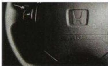
Airbag auf der Fahrerseite: Sorgt bei einem starken Frontalaufprall für zusätzliche Sicherheit.
