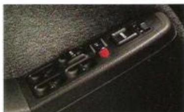
Schaltkonsole in der Fahrertür: Bequem in die Türarmlehne integriert, finden Sie die Bedienelemente für die Seitenfenster und die Außenspiegel.
