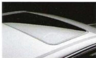
Sonnendach: Ein Schiebedach aus getöntem Glas öffnet und schließt sich automatisch auf Knopfdruck. Von Hand kann eine zusätzliche Sonnenblende vorgezogen werden.
