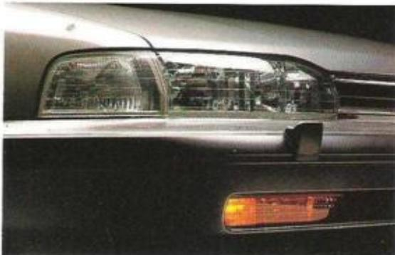
Die Reflektoren des Accord AeroDeck-Hauptscheinwerfers sind aus unzähligen kleinen Spiegelflächen geformt. Die Lichtstrahlen der Halogen-Glühlampen werden – ohne weitere Brechung durch die Abdeckscheibe – zielgerichtet auf die Fahrbahn gelenkt.
