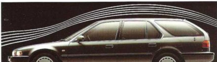
◁ Die aerodynamische Form des Accord AeroDeck ermöglicht einen sparsamen Verbrauch und geringere Windgeräusche. Der Luftstrom wird wirkungsvoll um das Fahrzeug herumgeleitet, wodurch es auch bei hohen Geschwindigkeiten richtungsstabil bleibt.
