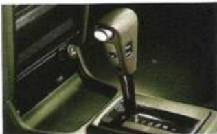
∧ Beim Viergang-Automatikgetriebe wird durch die Wandlerüberbrückungskupplung unnötiger Wandler-Schlupf verhindert. Der Fahrer wählt zwischen dem *NORMAL*-Programm für wirtschaftliches Fahren und dem *SPORT*-Programm, das die Schaltpunkte in einen höheren Drehzahlbereich verlegt.
