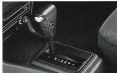
Per Knopfdruck schaltet die elektronisch gesteuerte Viergang-Automatik in den „Sport“-Modus.
