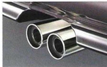
Die Modelle mit Einspritzmotor haben doppelte Endrohre.
