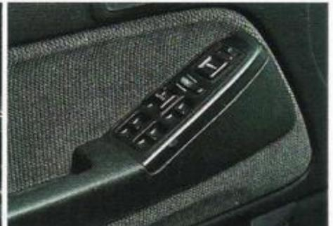
Eine durchdachte Konsole in der Armstütze der Fahrertür beinhaltet die Kontrolltasten für elektrisch bedienbare Fensterheber und Außenspiegel.
