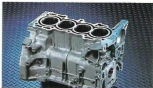
Ein aus Aluminium gefertigter Motorblock und Aluminium-Zylinderköpfe garantieren Robustheit und Stärke bei reduziertem Gewicht.
