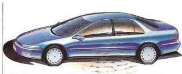
Ein konzeptionelles Bild ist der erste Schritt, um eine neue Auto-Idee zu untersuchen. Es ist Grundlage für Tests, Entwürfe und Produktion.
