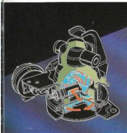
Eine elektronisch kontrollierte, hydraulische Motoraufhängung verbessert die Absorption von Vibrationen während des Startens und im Leerlauf.
