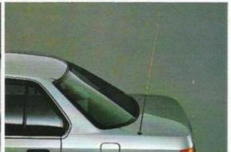
Eine automatisch ein- und ausfahrbare Motorantenne im Heck gehört ebenfalls zur Serienausstattung.
