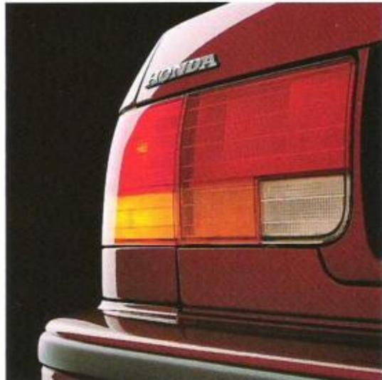
In der Heckbeleuchtung sind außer den Schlußleuchten die Bremslichter, die Rückfahrcheinwerfer und die Fahrtrichtungsanzeiger integriert.
