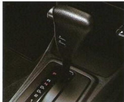
Im Sport-Modus werden die Schaltpunkte für die Gänge in höhere Drehzahlbereiche verschoben.
