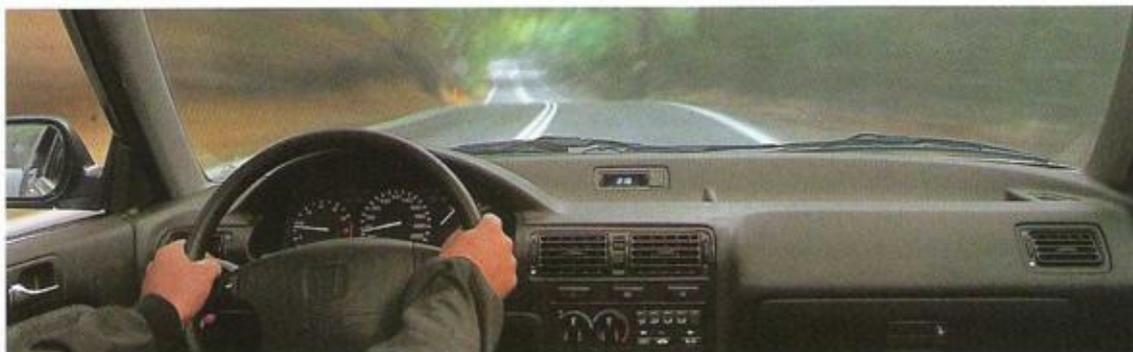
Der Neigungswinkel der Windschutzscheibe, die niedrige Linienführung der Motorhaube und dünne Dachstützen sorgen für ungehinderte Straßenübersicht.
