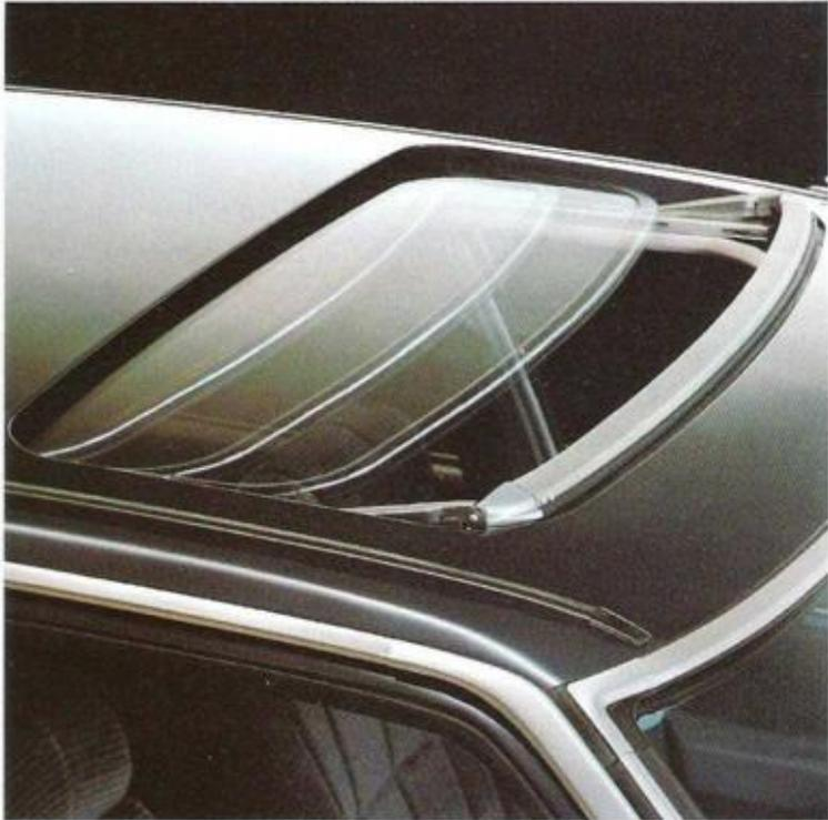
Elektrisch bedienbares Glasschiebedach mit Windabweiser (Aufpreis; für L und EX)
