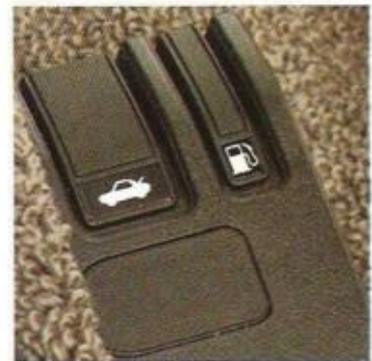
Heckklappen- und Tankdeckelentriegelung neben dem Fahrersitz (L und EX)
