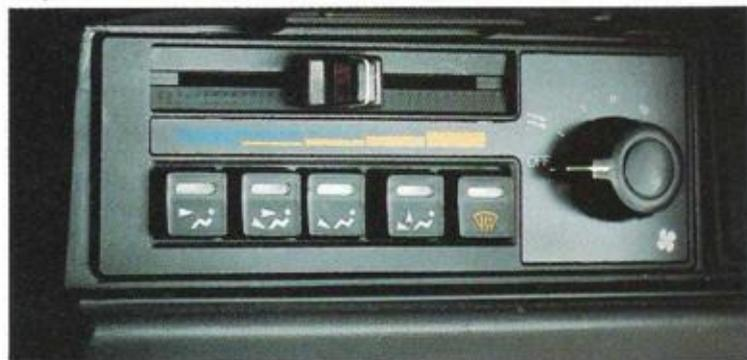
Tastenprogrammierbares Heizungs-/Lüftungssystem (L und EX)
