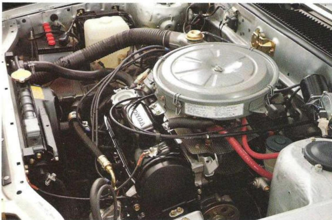
Quer eingebauter 1,6l, 59 kW/80 PS-Motor
