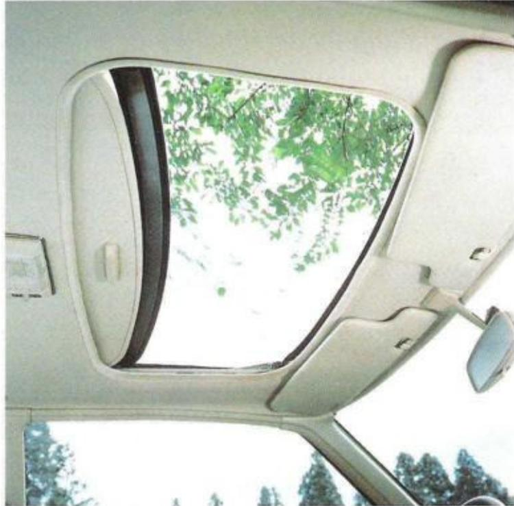
Elektrisch bedienbares Glasschiebedach geöffnet (Aufpreis; für L und EX)
