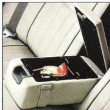
Ausklappbare Mittelarmlehne, hinten, mit Ablagefach (L, EX)
