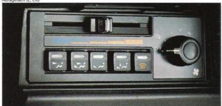
Tastenprogrammierbares Heizungs-/Lüftungssystem (L, EX)
