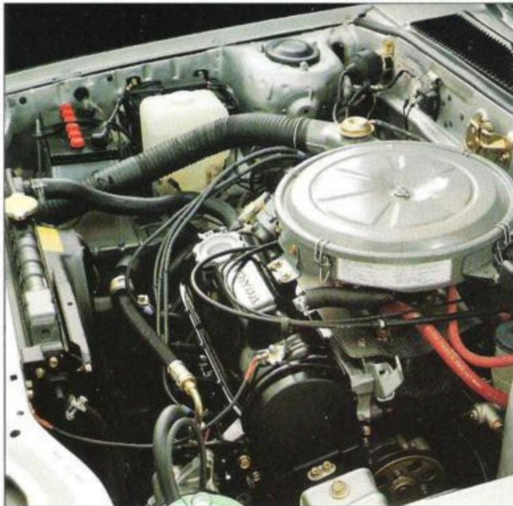
Quer eingebauter 1,6 l, 59 kW/80 PS-Motor
