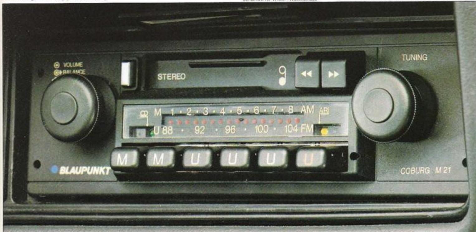
UKW/MW-Stereoradio mit Cassettenteil (EX)
