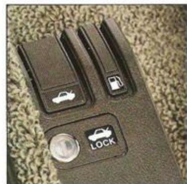
Kofferraumentriegelung mit Schloßsicherung und Tankdeckelentriegelung neben Fahrersitz (L, EX)
