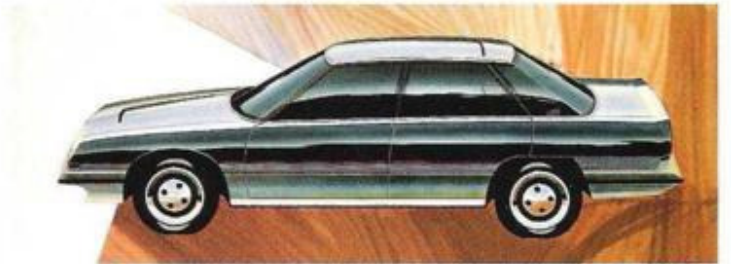
Nr. 3 Zwischen-Entwurf Hier handelt es sich um einen Versuch, mehr Schwung in das Design zu legen, da man es für zu konservativ hielt. Der messerscharfe Look des Erst-Entwurfs wurde wieder aufgegriffen, um ein keilförmiges Styling zu erzielen.
