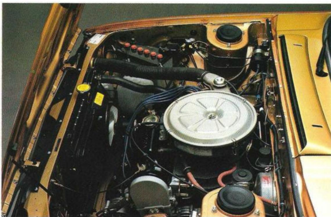
Quer eingebauter 59 kW-Motor (80 PS)
