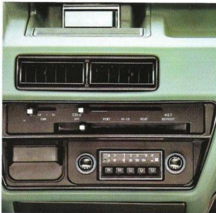
Heizungsarmatur, 3-Stufen-Gebläse, UKW/MW-Radio mit 5 Stationstasten
