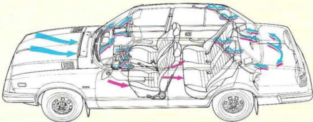
Heizungs- und Belüftungssystem
