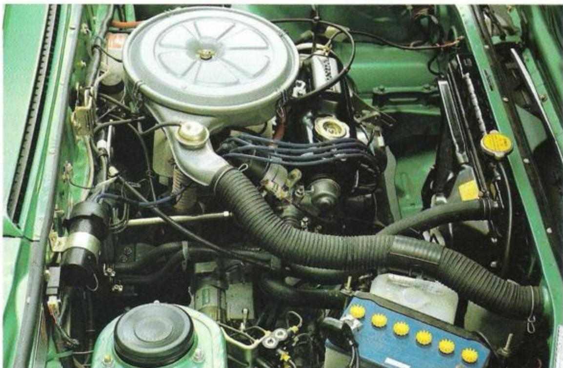
Quer eingebauter 59-kW-Motor (80 PS)
