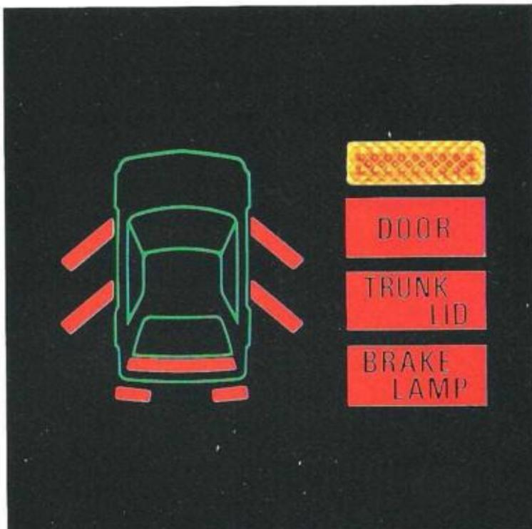
Sicherheitsindicator für Türen, Kofferraum und Bremsleuchten
