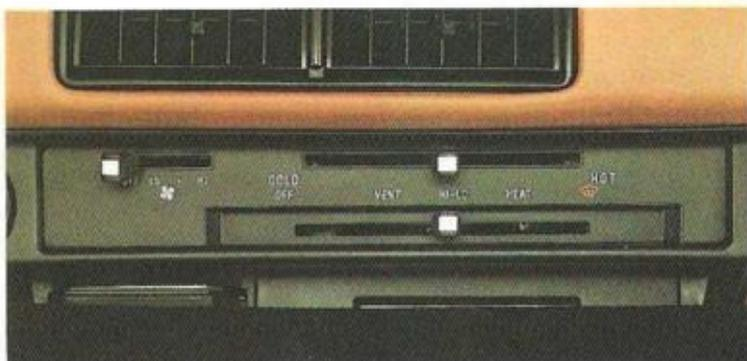
Heizungs- und Belüftungsregel-System, 3-Stufen-Gebläse
