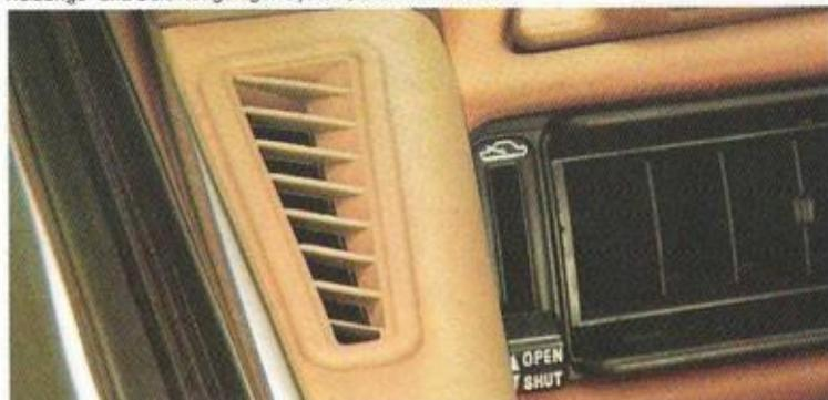
Belüftungs- und Beheizungsdüsen für vordere Seitenfenster
