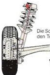
Die Schrägfederung der Räder mit schlagabsorbierenden Teleskop-Stoßdämpfern erhöht den Fahrkomfort.
