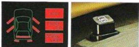
Der elektronische „Kontrollfernsehschirm“ warnt vor versehentlich nicht ganz geschlossenen Türen und defekten Bremsleuchten.
