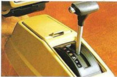
**Die 3-Stufen-„Hondamatic“.** Als echte Alternative zum 5-Gang-Getriebe hat Honda das automatische 3-Stufen-Getriebe „Hondamatic“ mit vorgeschaltetem Drehmomentwandler für Motoren mit kleinem und mittlerem Hubraum entwickelt. Es ist störungsunanfällig, beschleunigt ruckfrei und überträgt die ganze Kraft des Motors ohne Leistungsverlust auf die Straße.
