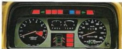
Tachometer mit Tageskilometerzähler, Tourenzähler, Kontrolleinrichtungen.
