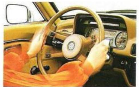
**Die Servolenkung.** Eine Exklusivität, die auch zur serienmäßigen Ausstattung des Accord/EX gehört: die progressive Servolenkung. Entsprechend der Fahrgeschwindigkeit wird die Servohilfe von einem Sensor automatisch angepaßt. Die Lenkung reagiert bei steigendem Tempo direkter – ein wichtiger Sicherheitsfaktor bei hohen Geschwindigkeiten. Bei niedrigen Geschwindigkeiten, zum Beispiel beim Parkieren, geht das Lenken spielend leicht.
