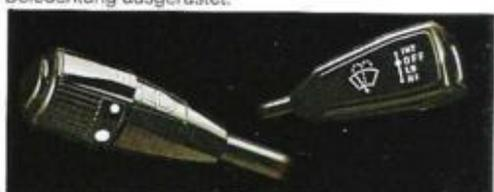
Ein Bedienungshebel links für alle Lichtfunktionen. Rechts der Hebel für die Scheiben-Wisch-/Waschanlage mit Lenkeinschleifung.
