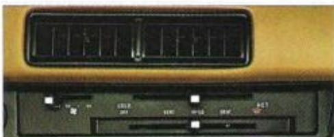
Das Heizungs-/Lüftungssystem ist stufenlos regulierbar, verfügt über getrennte Warm- und Kaltluftströme und ein 3-Stufen-Ventilationsgebläse.
