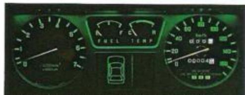
Die gut ablesbaren Instrumente sind mit reflexfreiem Glas abgedeckt und mit individuell einstellbarer Beleuchtung ausgerüstet.
