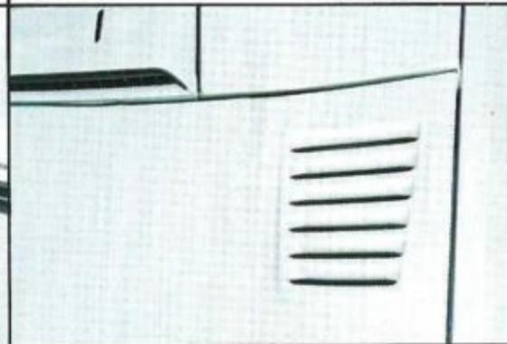
Staudruck-Entlüftungsschlitze in der Motorhaube.
