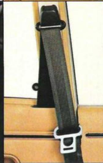
3-Punkt-Automatic-Sicherheitsgurte vorn, in Höhen versenkbar.
