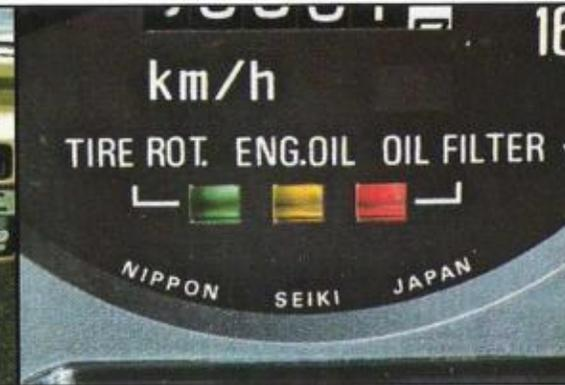
Wartungsintervall-Anzeige mit drei signalisierenden Farbfeldern für notwendigen Reifenwechsel, Motoröl- und Ölfilterwechsel.
