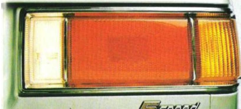
Große und deutlich sichtbare Kombinationsleuchten-Anlage für Rücklicht, Rückfahrcheinwerfer, Brems- und Blinklicht.
