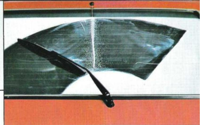
Große Heckscheibe mit integrierter Heckscheibenheizung und Wischer/Waschanlage.
