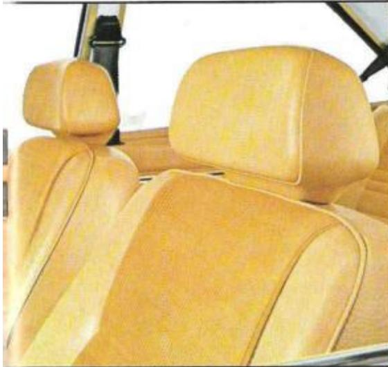
Einsteckbare sicherheitsproble und verstellbare Kopfstützen vorn.
