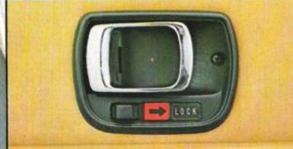
Sicher ist sicher. Seitlich in der Türverkleidung untergebrachte Türverriegelung.
