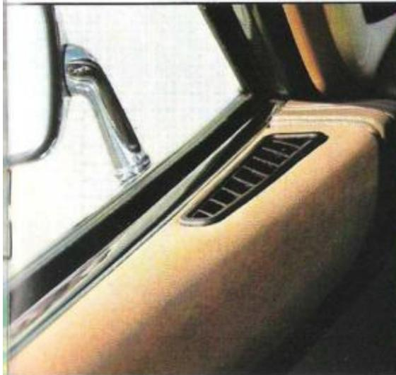
Belüftungs- und Beheizungs möglichkeit der vorderen Seitenfenster für klare Sicht bei jedem Wetter.
