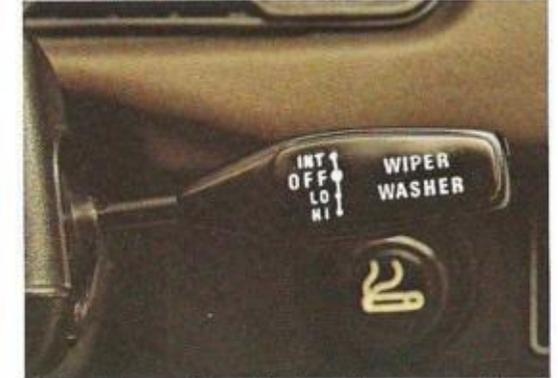
Schalter für zweistufigen Scheibenwischer mit zusätzlicher Intervallstellung und Scheibenwaschanlage.
