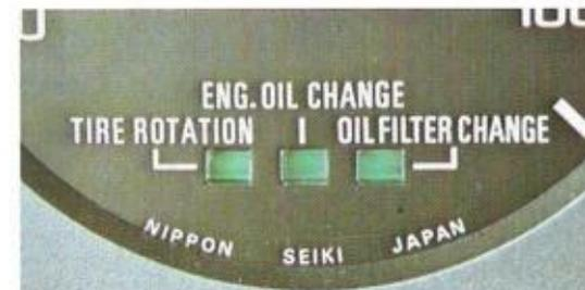
Optische Wartungsintervall-Anzeige durch drei signalisierende Farbfelder für notwendigen Reifenwechsel, Motoröl- und Ölfilterwechsel.
