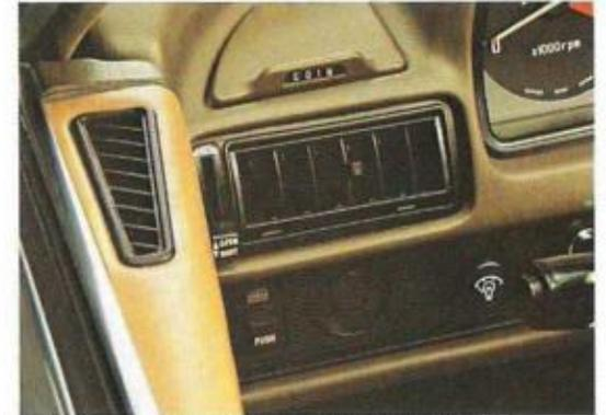
Belüftungs- und Beheizungsmöglichkeit der vorderen Seitenfenster für klare Sicht bei jedem Wetter.
