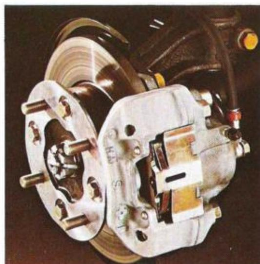
Scheibenbremsanlage vorn, unterstützt durch leistungsfähigen Unterdruck-Bremskraftverstärker.
