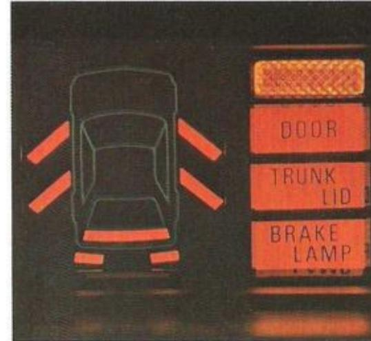
Sicherheitsindicator für nicht korrekt verschlossene Türen und Funktionsausfall der Bremsleuchten.
