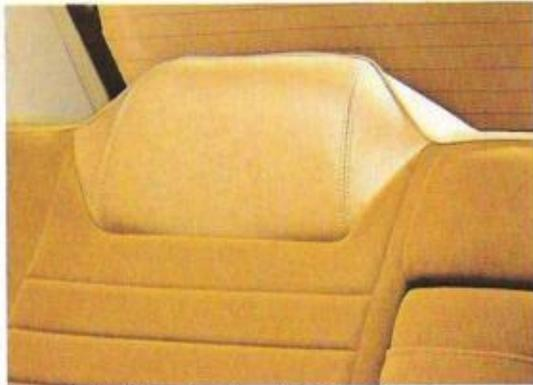
In der Rücksitzlehne integrierte Kopfstützen für die hinteren Beifahrer.
